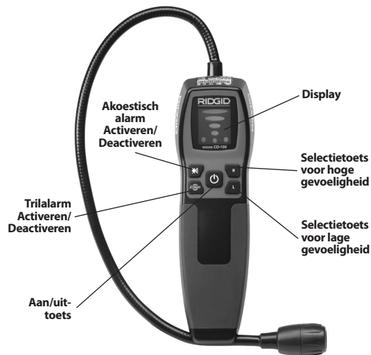
Figuur 2 – Onderdelen van de micro CD-100
