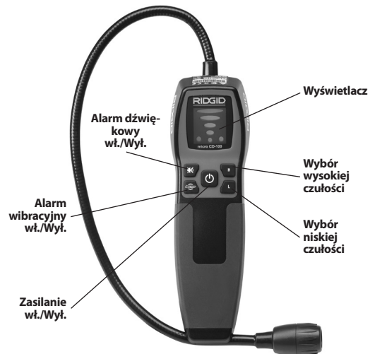
Rysunek 2 – Części micro CD-100
